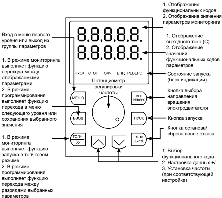
Рисунок 6 – Описание панели управления LCI-KP
