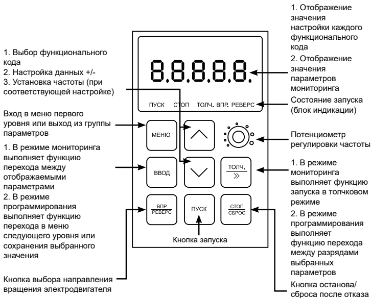
Рисунок 5 – Описание панели управления LCI-KP-S
